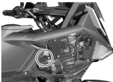
Tampa do depósito secundário do líquido de refrigeração
