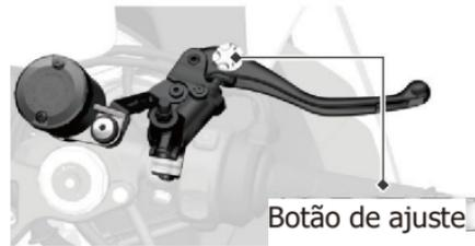
**Manete do travão:** Mova a manete do travão dianteiro para a frente do veículo, enquanto roda o botão de ajuste, solte a manete do travão dianteiro e teste se a distância é conveniente para operar a manete do travão dianteiro. Rode o botão de ajuste no sentido horário para aumentar a distância entre a manete do travão dianteiro e a manete de mudanças.
