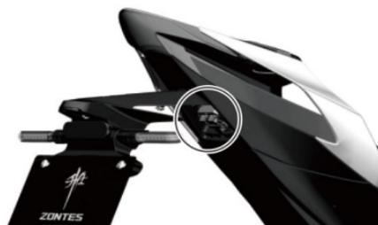
3. A fixação do PKE pode ser vista após a remoção da tampa inferior do guarda-lamas traseiro.
