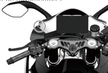
1. O kit de ferramentas também pode ser colocado na tampa decorativa esquerda do painel de instrumentos, e o engate pode ser removido para revelar o espaço interior.
