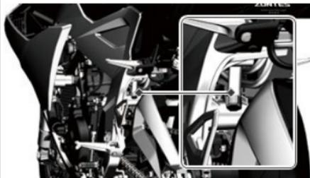
1. Conforme indicado na figura, o tubo de óleo está localizado na cavidade de entrada de ar esquerda. Remova o clipe de retenção com um alicate de pontas, puxe o bujão de plástico, drene o óleo usado e, em seguida, volte a instalar tudo seguindo os passos acima pela ordem inversa após concluir a drenagem.
