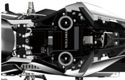
2. Utilize uma chave de fendas de tipo Torx T25 para remover os dois parafusos M6x12 e remova a tampa superior do compartimento do dispositivo elétrico.
