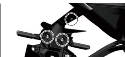
2. Desmonte a tampa decorativa esquerda do painel de instrumentos e retire a chave de fendas sextavada de tipo Torx T25 e o batente em cruz da bolsa de ferramentas.
