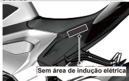
Quando a carga da pilha da chave de indução está baixa ou não há pilha na chave, pode ligar o veículo através do modo de indução não elétrico. As etapas específicas são as seguintes:
