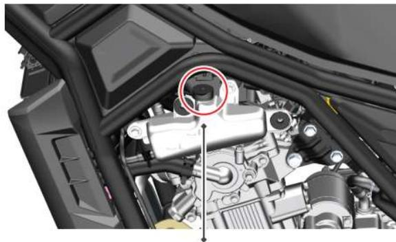
A tampa do depósito de água auxiliar
