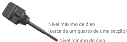
Sendo o motor durável ou não, é importante selecionar um óleo de alta qualidade e trocar óleo por um novo com regularidade. A inspeção regular do nível de óleo do motor e a substituição regular do óleo do motor e do filtro de óleo são duas tarefas importantes que devem ser realizadas aquando da manutenção.
