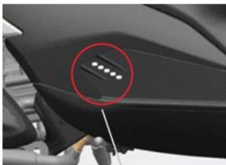
Observe o indicador de nível de líquido do depósito de água auxiliar
