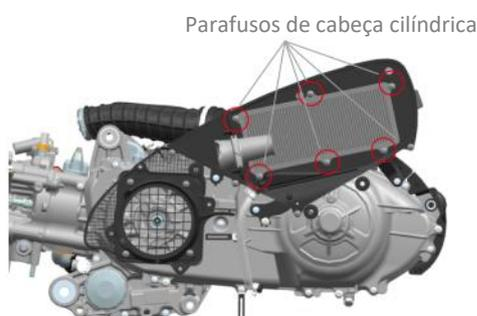
Parafusos de cabeça cilíndrica
