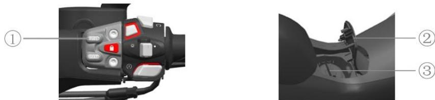
O depósito de combustível está localizado debaixo da tampa do depósito de combustível. Quando abrir a tampa do depósito de combustível, certifique-se de que o botão de extinção do motor está desligado, pressione o botão do depósito de combustível ①, a tampa do depósito ② irá abrir-se automaticamente, rode o tampão do depósito de combustível ③ para a esquerda. Ao colocar o tampão, siga os passos anteriores pela ordem inversa.
