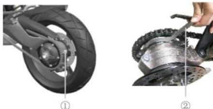
Passo 1: Solte o parafuso M16x1.5 mostrado na imagem com uma chave dinamométrica de 100 N e o sextavado 21# externo. Tenha em atenção que não é necessário que fique completamente desparafusado.
