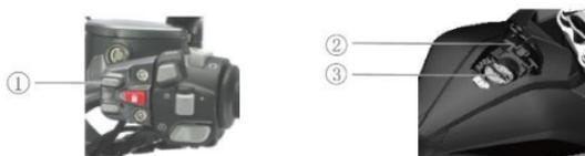
O depósito de combustível está localizado em frente à almofada do assento. Ao abrir a tampa externa do depósito de combustível, certifique-se de que o interruptor de desligar do motor está desligado e prima a tampa do depósito de combustível.
