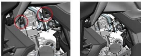
Desmontar a vela de ignição
